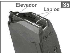
9. INSPECCIÓN DEL CARGADOR. Examine todos los cargadores en busca de suciedad o daños visibles; compruebe con especial cuidado si hay labios de alimentación extendidos o dañados, y elevadores (32) (Foto 35) del cargador rotos. Oprima el elevador con la punta de su dedo y libérela. El elevador debe saltar hacia arriba completamente, y no debe atascarse dentro del tubo del cargador.
