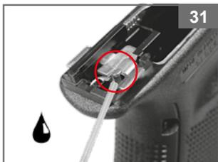
2. Coloque una gota de aceite para armas o de limpiador-lubricante-conservante donde el extremo trasero de la varilla del gatillo (26) toca el conector (24) en la esquina posterior derecha del armazón (Foto 31).
