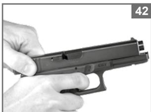
2. **PRUEBA DE REGRESO DEL GATILLO.** Con la boca de su pistola GLOCK apuntada hacia una dirección segura, apriete el gatillo y sosténgalo hacia atrás. Se debe oír y sentir la liberación del percutor. Mientras continúa sosteniendo el gatillo hacia atrás, tire de la corredera hacia atrás (Foto 42) y suéltela, dejando que avance bruscamente. Ahora suelte el gatillo. El gatillo debe regresar a la posición hacia adelante. Repita varias veces la prueba de regreso del gatillo.
